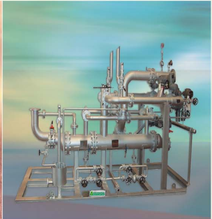
PRESION DE ASPIRACION: 45 TORR. EXTRACCION A VACÍO DE UNA MEZCLA DE AIRE Y VAPOR EN UN AERO-CONDENSADOR
